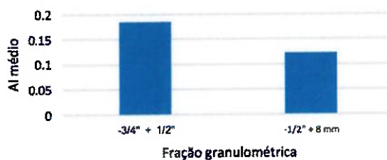
Figura 12. Resultados do ensaio de AI de Bond para diferentes granulometrias da amostra 2 (zinco).
