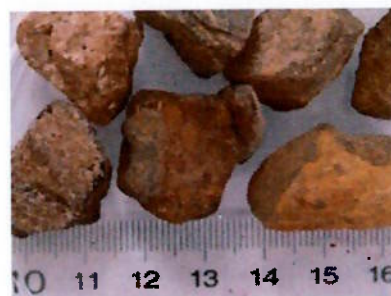
Amostra 5 (minério de ferro) de 6,3 mm a 4 mm (esquerda) e \frac{3}{4} " a \frac{1}{2} " (direita)
