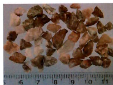
Amostra 4 (minério de ouro) de 6,3 mm a 4 mm (esquerda) e \frac{3}{4} " a \frac{1}{2} " (direita)
