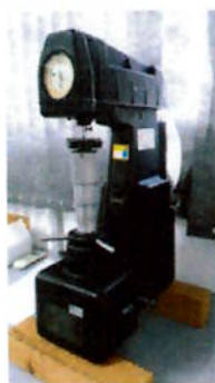
Figura 10. Equipamento disponível no IPT utilizado para determinar a dureza Rockwell B e C
