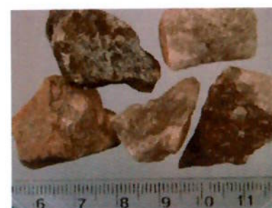
Amostra 4 (minério de ouro) de 6,3 mm a 4 mm (esquerda) e \frac{3}{4} " a \frac{1}{2} " (direita)
