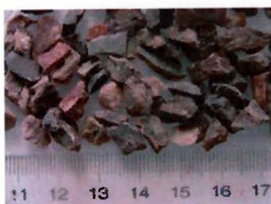
Amostra 9 (minério silicatado de zinco) de 6,3 mm a 4 mm. Da esquerda para direita, alimentação, concentrado e rejeito
