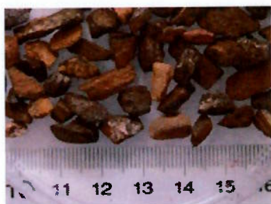
Amostra 5 (minério de ferro) de 6,3 mm a 4 mm (esquerda) e \frac{3}{4} " a \frac{1}{2} " (direita)
