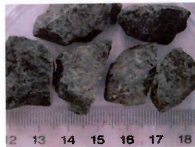
Amostra 6 (diabásio) de 6,3 mm a 4 mm (esquerda) e \frac{3}{4} " a \frac{1}{2} " (direita)
