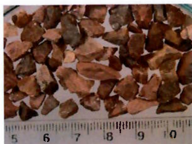
Amostra 2 (zinco) de 6,3 mm a 4 mm (esquerda) e \frac{3}{4} " a \frac{1}{2} " (direita)
