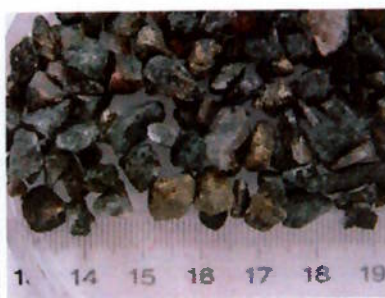
Amostra 10 (minério sulfetado de cobre) de 6,3 mm a 4 mm. Da esquerda para direita, alimentação, concentrado e rejeito
