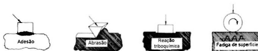
Figura 2. Mecanismos básicos de desgaste (adaptado de Zum Gahr, 1987)
