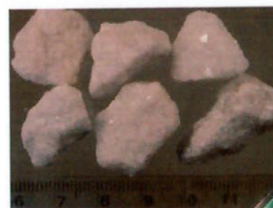
Amostra 3 (brita para jardinagem) de 6,3 mm a 4 mm (esquerda) e \frac{3}{4} " a \frac{1}{2} " (direita)
