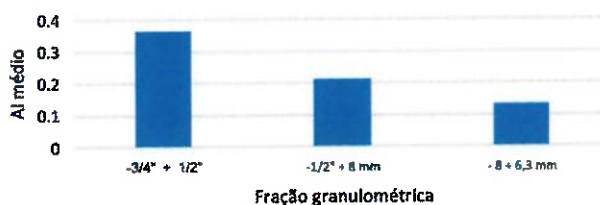
Figura 15. Resultados do ensaio de AI de Bond para diferentes granulometrias da amostra 6 (diabásio).
