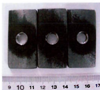
Figura 23. Placas utilizadas nos ensaios LCPC das amostras de minério sulfetado de cobre (da esquerda para a direita, alimentação, concentrado e rejeito)
