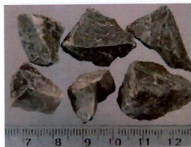
Amostra 1 (calcário) de 6,3 mm a 4 mm (esquerda) e \frac{3}{4} " a \frac{1}{2} " (direita)
