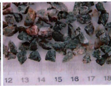
Amostra 10 (minério sulfetado de cobre) de 6,3 mm a 4 mm. Da esquerda para direita, alimentação, concentrado e rejeito
