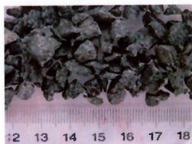
Amostra 6 (diabásio) de 6,3 mm a 4 mm (esquerda) e \frac{3}{4} " a \frac{1}{2} " (direita)
