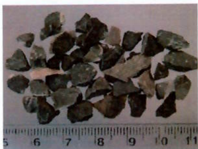
Amostra 1 (calcário) de 6,3 mm a 4 mm (esquerda) e \frac{3}{4} " a \frac{1}{2} " (direita)
