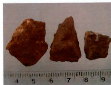
Amostra 2 (zinco) de 6,3 mm a 4 mm (esquerda) e \frac{3}{4} " a \frac{1}{2} " (direita)
